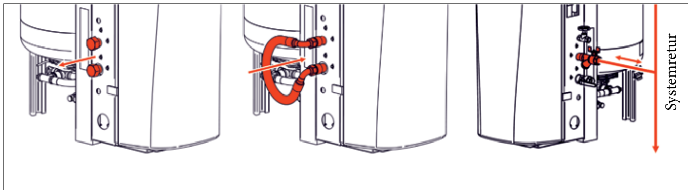
Illustration 14: Anslutning av anslutningarna till bypass-setet och anslutning till systemreturen
